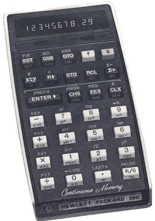
**Particularités :** DSZ (cf TI 57) et ISZ (incrémentatation et non décrémentatation, avec test analogue à celui des DSZ); notation ingénieur; touches NOP, DEL, insertion automatique; adressage indirect; touche pourcentages; mémoire continue (le programme ne s'efface pas); pas de flags; pas de factorielle; pas de cartes magnétiques; pas de possibilités d'impression; pas de module enfichable.
