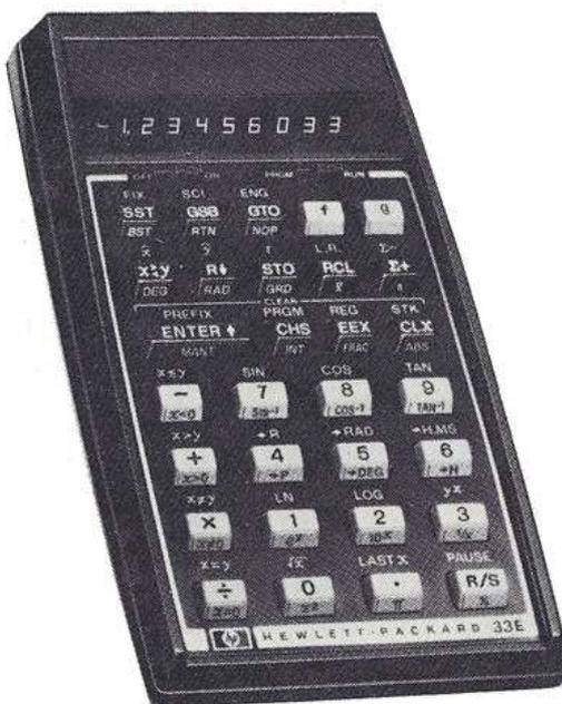
**Particularités :** adressage indirect ; droite de régression linéaire, coefficient de corrélation ; contrôle automatique avec affichage d'un code d'erreurs ; notation ingénieur ; touche NOP (opération blanche) ; pas de DSZ ; pas de flags ; pas de labels ; pas de factorielle ; pas de cartes magnétiques ; pas de possibilités d'impression ; pas de modules enfichables ; pas de mémoire continue.
