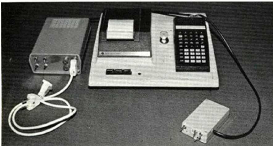
Vue générale du système avec calculatrice de poche, imprimante et interface de commutation avec connexion câbles.
